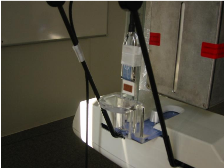
Bild 1: Dosisdetektor und Objekt bildempfängernah fixieren
